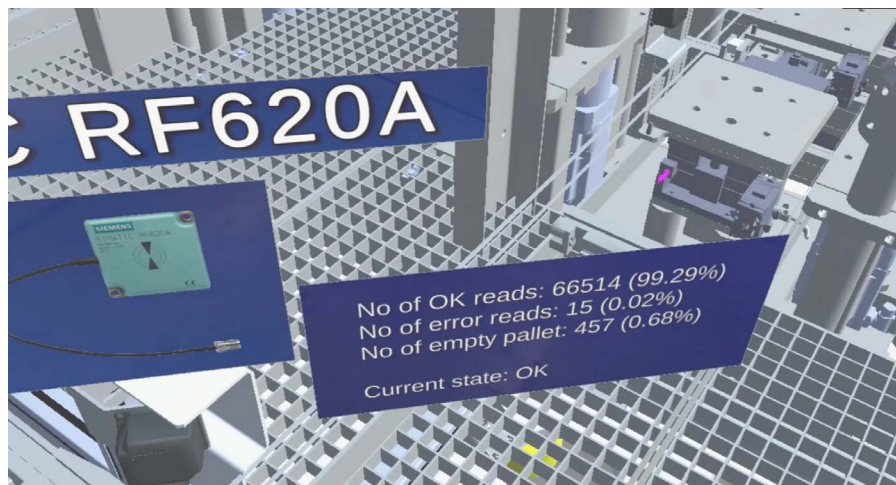
PRZYKŁADOWY WIDOK Z OKULARÓW ROZSZERZONEJ RZECZYWISTOŚCI. CYFROWY BLIŹNIAK STACJI TESTU CHARAKTERYSTYKI Z WYŚWIETLONYM STATUSEM WYBRANEGO ELEMENTU.
