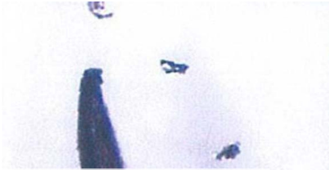
RYS. CZĄSTKA ALUMINIOWA O WYMIARACH 304 X 179 μM W PORÓWNIANIU DO KOŃCÓWKI IGŁY
