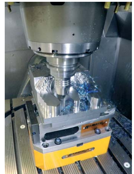
Rys.5. Frez 12 mm i głębokość skrawania 24 mm
