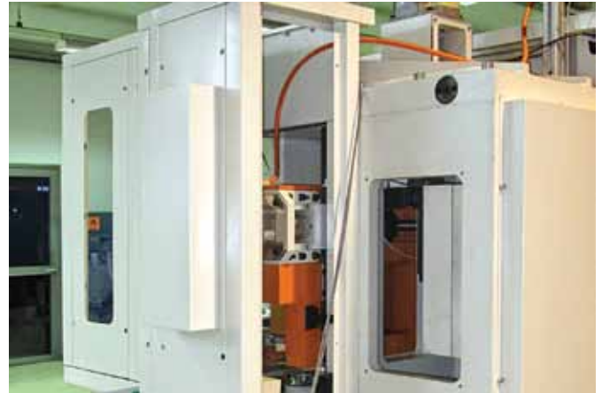
Rys.2. Brak osłony zwraca swoją uwagę poprzez jaskrawy kolor elementów, które osłona zakrywa, gdy jest założona
