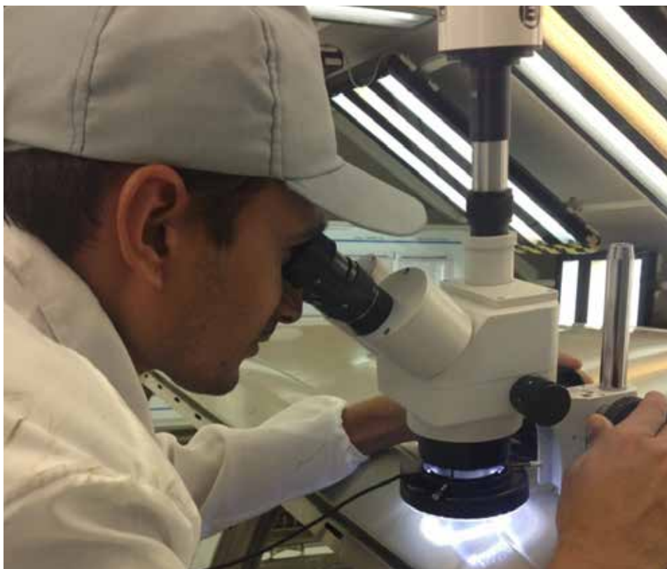
PDA proces. Analiza stereoskopowa karoserii po Ecoat
