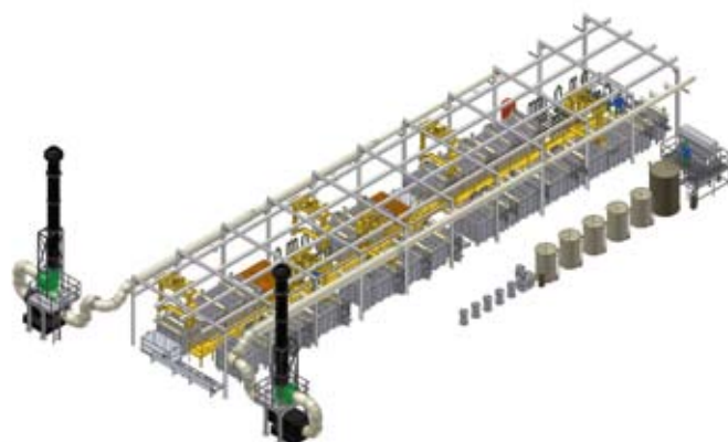
Automatyczna linia do galwanizowania tworzyw sztucznych: ABS, ABS-PC, polamidu i poliestru
