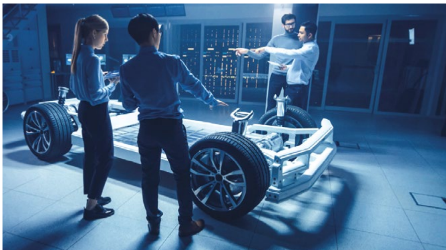
RYS. 2: DZIĘKI MOŻLIWOŚCI ZASTOSOWANIA WIĘKSZYCH AKUMULATORÓW, NATYWNE PŁYTY PODŁOGOWE SAMOCHODÓW ELEKTRYCZNYCH ZAPEWNIĄJĄ WIĘKSZĄ ELASTYCZNOŚĆ KONFIGURACJI I WIĘKSZY ZASIĘG NAPEWU.
